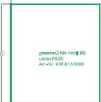
Das greenteQ Klima Konform Profil BS unten 80/90 mm wird als unteres Profil für das greenteQ Klima Konform System Blindstockmontage eingesetzt. Zusätzlich kann es auch für das greenteQ Klima Konform System Standardmontage eingesetzt werden.
