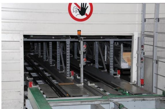
Dreh- und Angelpunkt der voll automatisierten Kasto-Anlage von VBH in Ilsfeld sind die Schleusen für die Ein- und Auslagerung der über 1.400 Kassetten.
