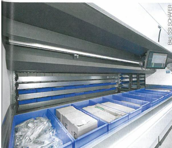
Die Tablare können im Raster von 25 mm eingelagert werden. Über diese Einstellung lassen sich geringstmögliche Einlagerungsabstände erzielen.
