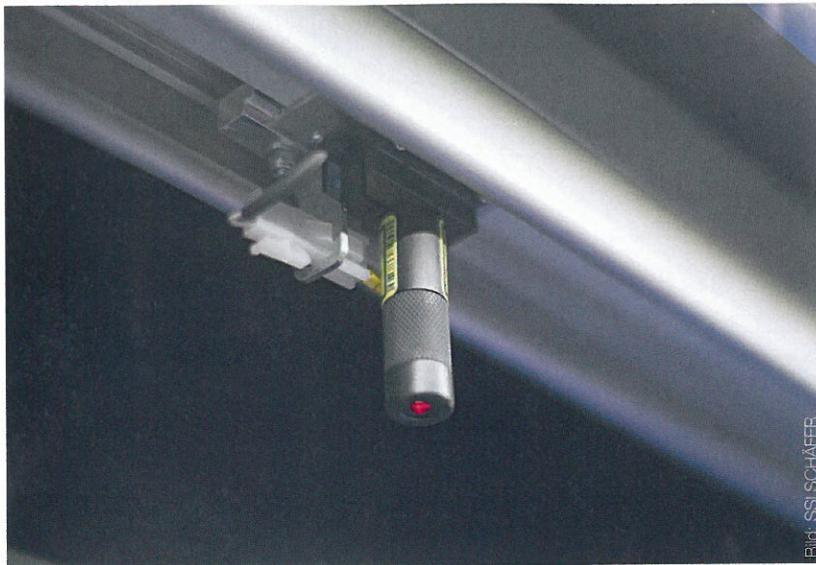
Das Laserpointer-System verhindert Greiffehler durch eine exakte Kennzeichnung der Entnahmeposition.
