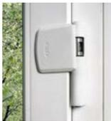
Die Fenster-Zusatzsicherung ABUS FAS101 dient der Sicherung der Scharnierseite. Die Griffseite sollten Sie gesondert absichern. Beim Öffnen des Fensters dreht FAS101 einfach mit, vor dem Kippen muss der Sicherungsbolzen entriegelt werden. Nach Kippstellung des Fensters muss der Bolzen dann wieder eingedrückt werden. Montiert wird die Scharnierseitensicherung auf dem Fensterflügel und dem Rahmen. Dank ihrer schmalen Konstruktion kann FAS101 auch bei engen Einbauverhältnissen eingesetzt werden.
